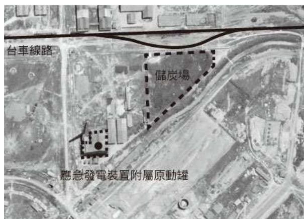
【圖 3-18】應急發電裝置附屬原動罐工場區域配置
